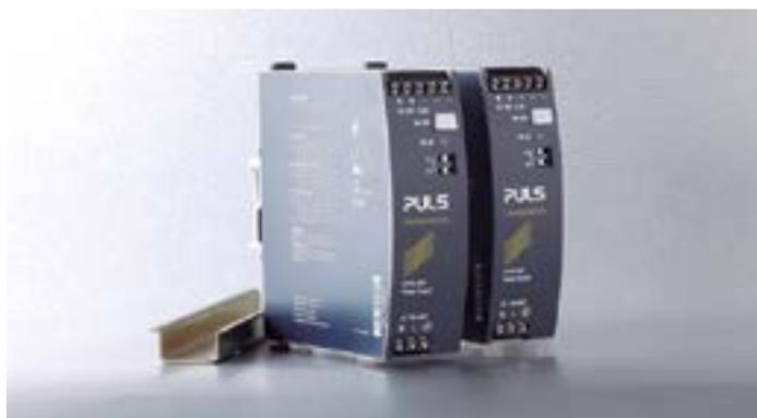
Además, la serie CP incluye reservas de energía del 20%: 288W de energía están disponibles constantemente hasta una temperatura de + 45°C. Para la activación de los fusibles en el encendido, la CP10 puede suministrar tres veces la corriente de salida especificada (en breves periodos de tiempo).
