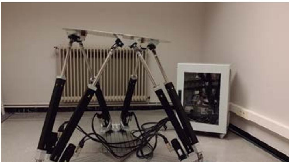
Figura 1. Plataforma Stewart con armario de instalación de CompactRIO
