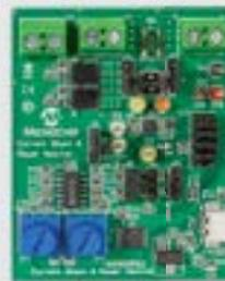
El PAC1921 es un dispositivo de supervisión de potencia dedicado con una salida analógica configurable. Este dispositivo es único porque toda información relacionada con la potencia se encuentra disponible en el interface compatible con 2 hilos/I<sup>2</sup>C, mientras que la potencia, la corriente o la tensión está disponible en la salida analógica.
