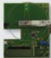
Esta tarjeta de demostración está diseñada para evaluar las prestaciones del convertidor A/D de 18 bit de bajo consumo en el diseño de una báscula electrónica. Además del MCP3421 hay un amplificador operacional MCP6V07 de bajo ruido y puesta a cero automática. Se puede utilizar para investigar las consecuencias de
