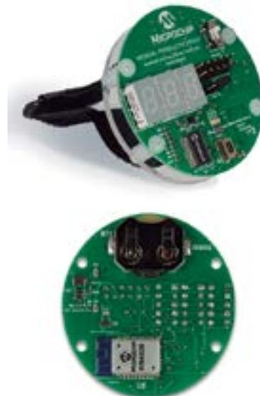
Figura 3. Vista frontal y trasera de la tarjeta de demostración del podómetro.
