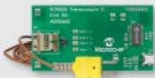
La tarjeta de evaluación MCP9600 le permite evaluar fácilmente las características del convertidor de EMF del termopar a grados Celsius MCP9600 utilizando un termopar de tipo K. El dispositivo también admite los tipos J, T, N, E, B, S y R, que se pueden evaluar sustituyendo el conector de termopar de tipo K con los conectores correspondientes.
