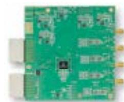
La tarjeta de evaluación VTLA con convertidor A/D de 16 bit y 200 Msps MCP37X3X-200 le permite evaluar las prestaciones y las funciones de proceso de señal digital de la familia MCP37X3X-200 de convertidores A/D segmentados de 16 bit y 200 Msps. Se utiliza
