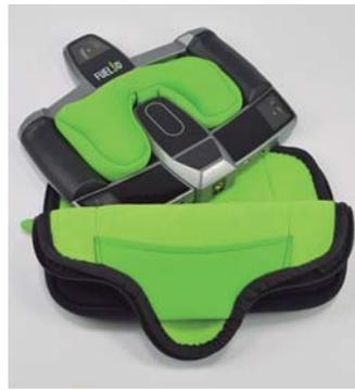
rencia en lo que a asequibilidad se refiere para los escáneres 3D portátiles de alto rendimiento; además, es rápido, versátil y fácil de usar. El usuario coloca un objetivo de rastreo óptico en el objeto que desea digitalizar, como referencia para la corrección de movimiento y, a continuación, con un disparo de un solo clic (0,1 segundos) captura todas las imágenes necesarias para crear el modelo.
