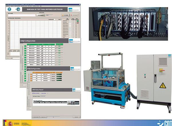
Figura 3. Sistema de ensayo y aplicación software en LabVIEW para la caracterización de motores eléctricos In-Wheel.
