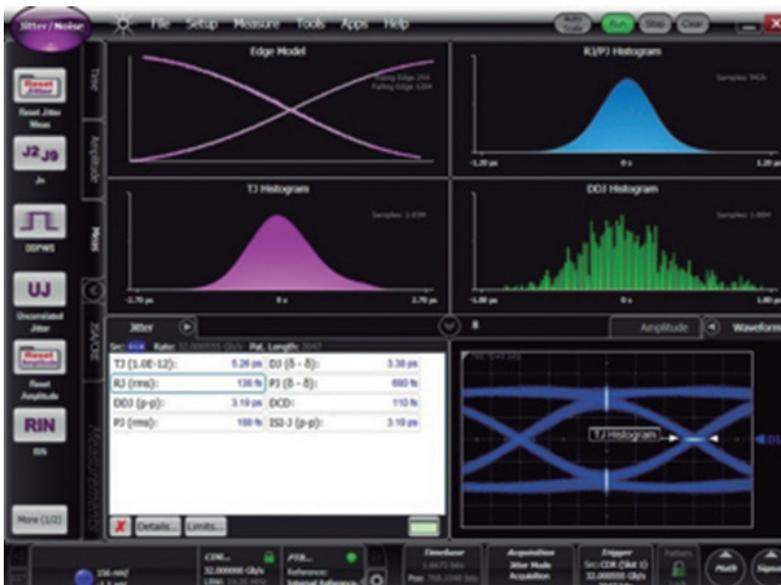
Figura 3. PRBS211-1 de 32 Gb/s que muestra 138 fs RJ (rms) generados por el Keysight M8195A.
