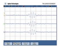
AWG de dos canales y utilizando esas señales para impulsar las entradas de modulación de banda ancha I y Q del generador vectorial de señales.
