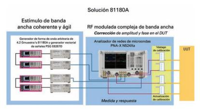
Figura 1. El sistema de simulador/calibrador consta de dos secciones principales e incluye nueve instrumentos
