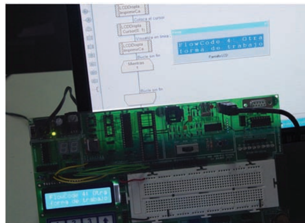
Figura 57. Ejecución del Ejemplo 4 sobre el laboratorio USB-PIC'School
