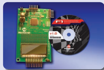
Plataforma de Evaluación PIC16F193X 'F1' - DM164130-1
