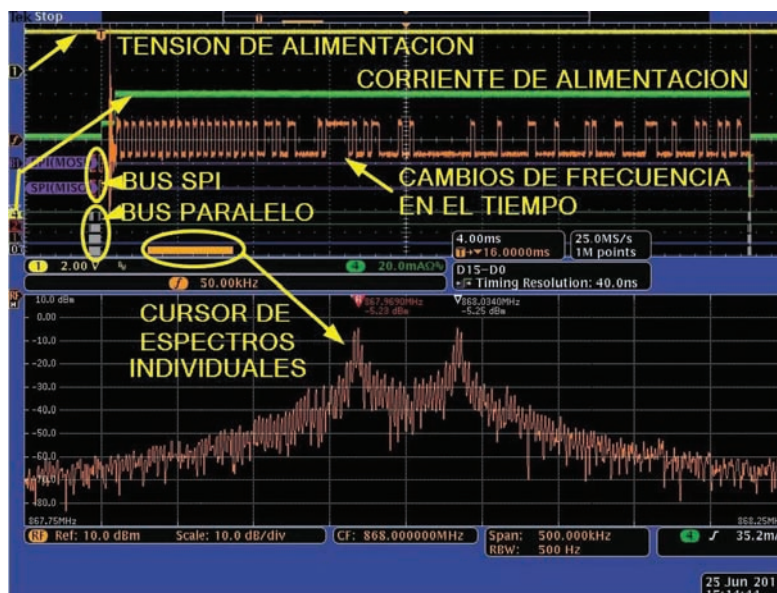
Figura 2. Diseño y depuración de un sistema embebido con un transmisor de 868 MHz y modulación FSK. Canal 1: Conexión a la alimentación; canal 4: Corriente de la alimentación; BUS SPI: Comandos de control; Bus Paralelo; Canales 0 a 3; Canal F: Variación de la frecuencia en función del tiempo.
