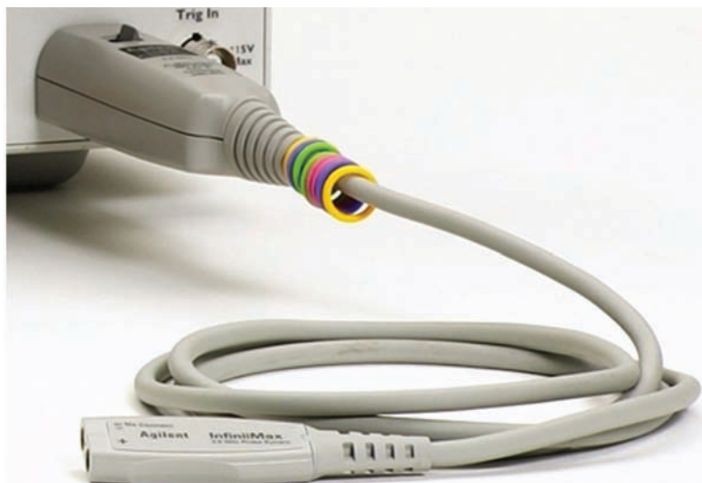
Figura 4. Numerosas sondas activas modernas utilizan interfaces de sondas inteligentes que proporcionan alimentación y actúan como enlaces de comunicaciones entre sondas compatibles y el osciloscopio.
