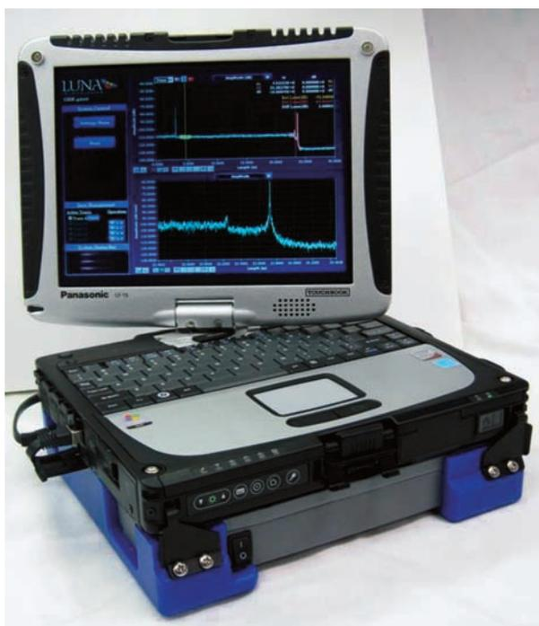
disminución de pérdidas de inserción respecto uno equilibrado totalmente. La pérdida típica con un acondicionador de Luna es de 5 – 6 dB. Lo que permite un máximo rango dinámico mientras mantiene sensibilidad a defectos que afectan a todo el corte transversal de la fibra.
