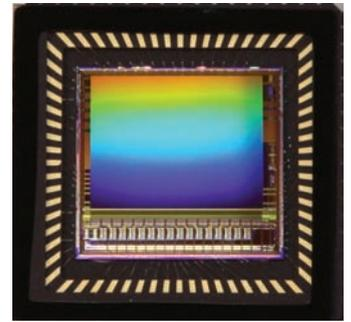
óptico de 2/3" y ofrece cuatro canales LVDS paralelos.
