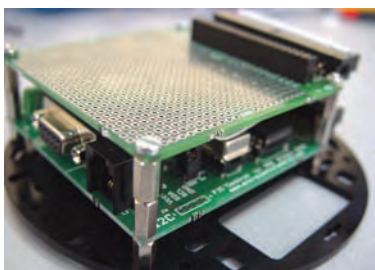
Figura 10. La PIC'Project se sujeta mediante separadores metálicos sobre la tarjeta PIC'Control.
