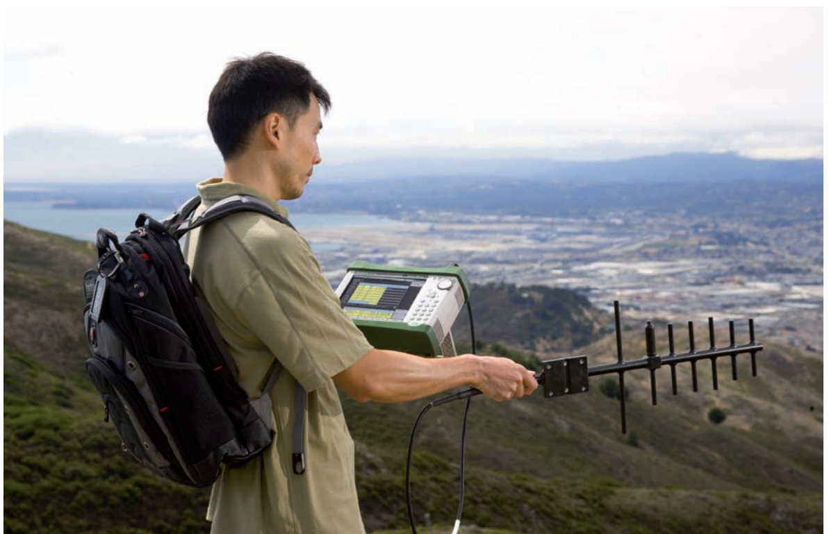
Fig. 5 Medidas EVM con una antena Yagi
