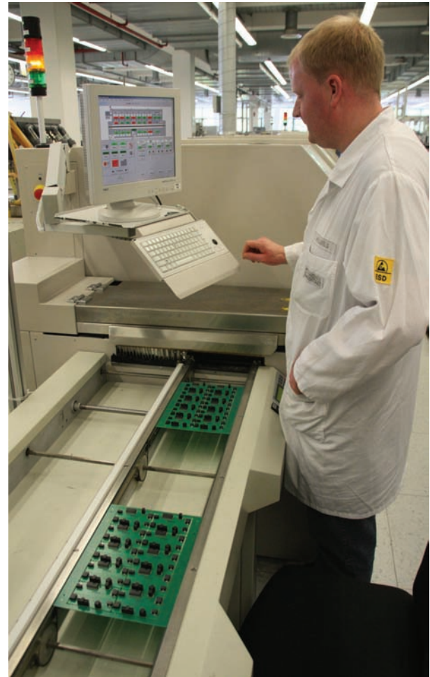
Figura 3. Para su aprobación conforme a la norma IPC/JEDEC J-STD-020D, los componentes pasan por tres ciclos en el horno de reflujo y una inspección final minuciosa.
