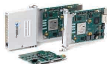
Figura 7. Los sistemas NI FlexRIO, formados por un módulo adaptador y un módulo PXI FPGA, ofrecen un nuevo nivel de personalización para aplicaciones de LabVIEW FPGA.
