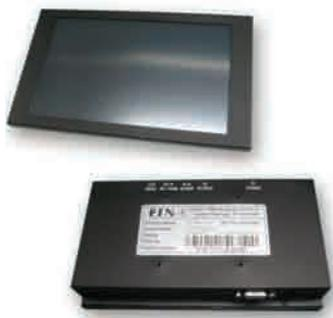
Este monitor está fabricado con una carcasa metálica e incorpora 4 taladros en la parte posterior para facilitar la sujeción a cualquier tipo de soporte. La conexión a un PC o a una placa embebida se hace a través del conector del puerto VGA y el sensor táctil se conecta al puerto serie RS-232. También está disponible en versión sin pantalla táctil.
