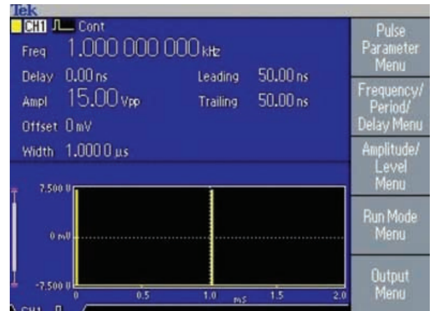
Figura 5. El AFG3011 muestra la amplitud de la salida directamente en la pantalla.
