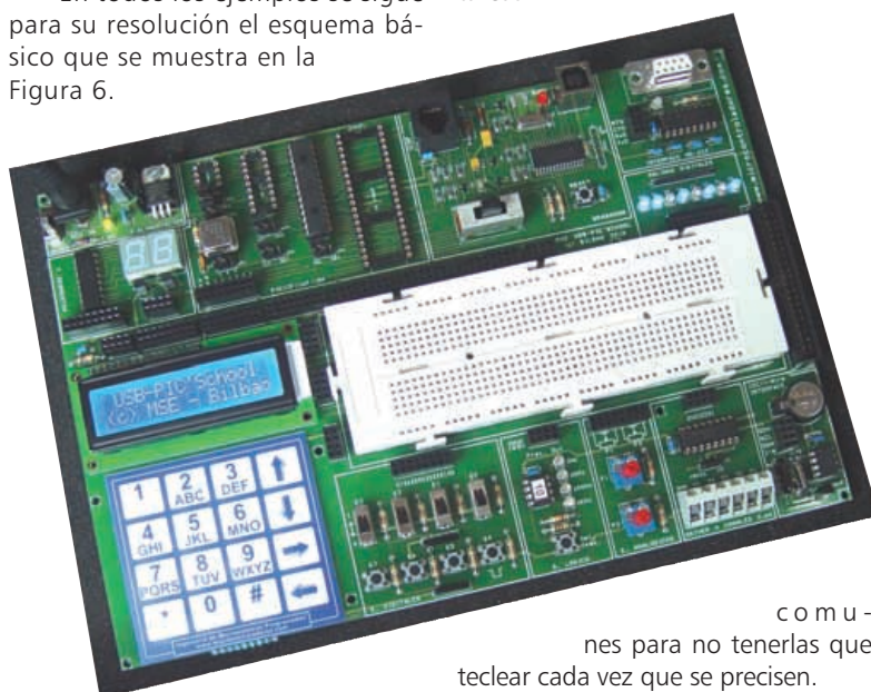
Figura 5. Fotografía de la tarjeta principal del USB-PIC'School en la que se aprecian todos los periféricos que soporta.
