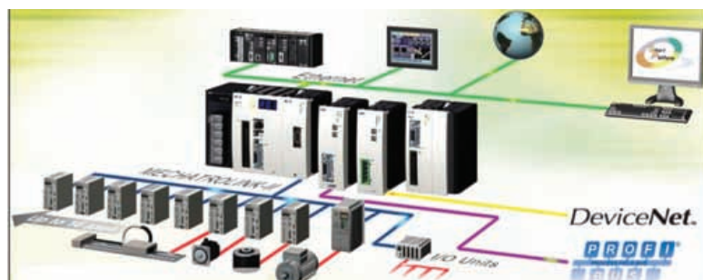
Esquema solución Stand-alone (independiente) con Trajexia de 16 ejes
