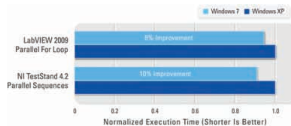
Figura 3. Con Windows 7, el rendimiento de una aplicación LabVIEW con cuatro ciclos en paralelo en una máquina de cuatro núcleos experimentó un incremento en el rendimiento del 10 por ciento comparado con Windows XP.
