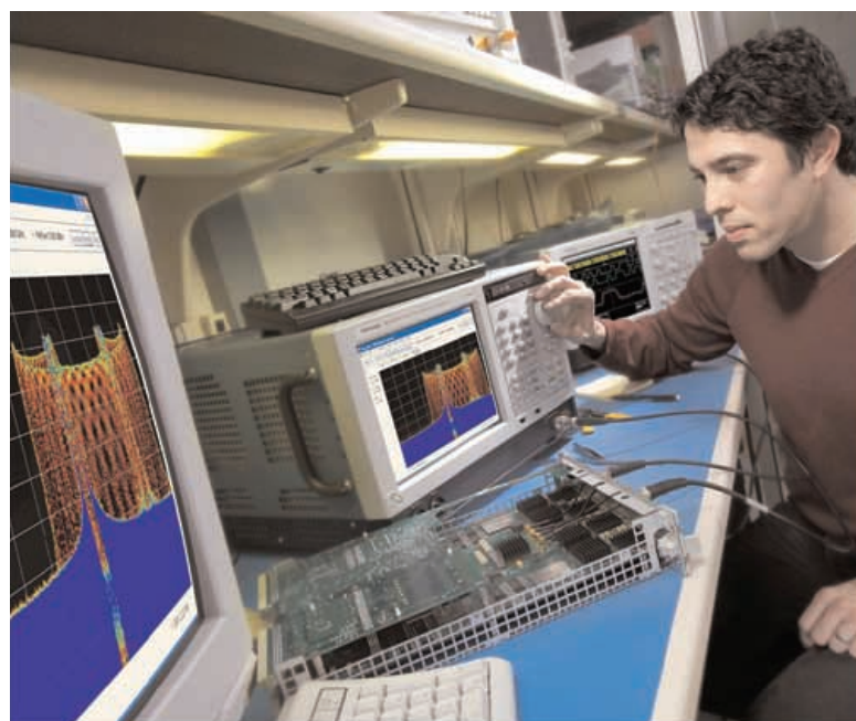
Figura 33. La visualización del espectro con DPX ofrece una capacidad visual intuitiva mediante colores en vivo que permite ver los cambios transitorios de la señal en el dominio de la frecuencia, transmitiendo una inmediata confianza sobre la estabilidad del diseño o visualizando inmediatamente un fallo cuando se produzca.
