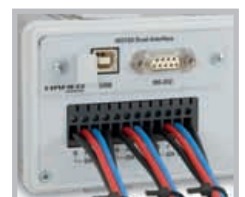
Salidas en la parte trasera útiles en integraciones en sistemas de rack
