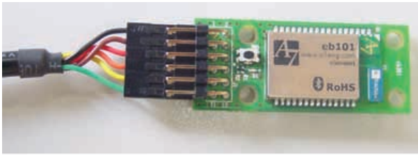
Figura 11. Fotografía que muestra la conexión del cable adaptador TTL-RS232R5V con las patitas 1, 3, 5, 7, 9 y 11 del módulo eb301.
