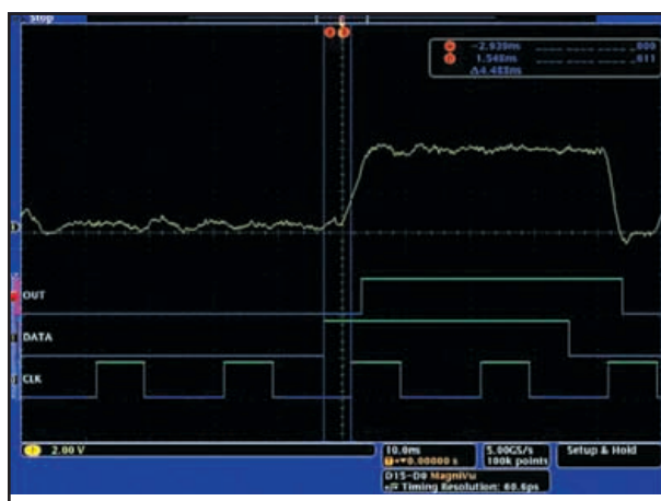
Figura 21. Funcionamiento correcto de la salida Q del Flip-Flop D con el dato presente en D durante 4,488 nseg antes del flanco de subida del reloj
