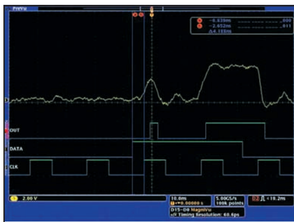
Figura 20. Visualización analógica del error en la salida Q del Flip-Flop D.
