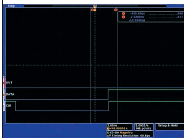
Figura 22. Disparo del MSO sobre el cambio de los datos del Flip-Flop D dentro de la ventana de "setup&hold" definida con los cursores 'a' y 'b' situados alrededor del flanco de subida del reloj.
