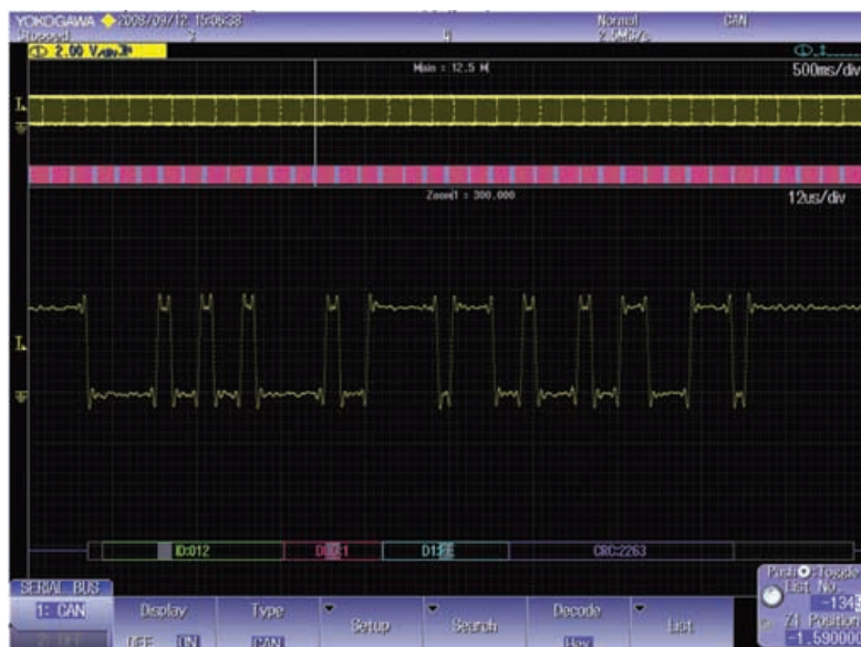
Figura 9. Forma de onda CAN (y ventana de zoom) de 125 Mpts y 5 seg. de duración.
