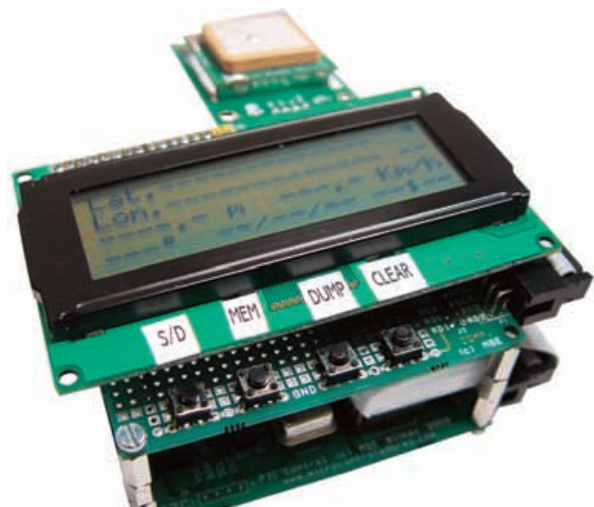
Figura 13. Fotografía que muestra el conjunto de las dos tarjetas que conforman el KIT GPS, apiladas mediante unos separadores intermedios.
