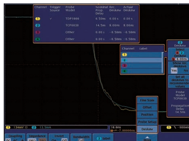
Figura 6. Corrección utilizando el valor nominal de los tiempos de 'Skew' entre las sondas de tensión y corriente.
