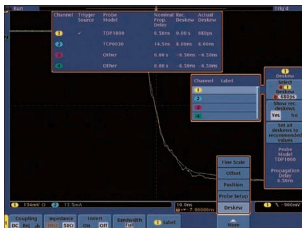
Figura 8. Eliminación manual del 'skew' entre las sondas de tensión y corriente.
