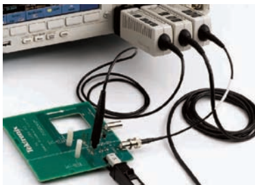
Figura 7. Generador de pulsos y dispositivo de 'deskew' de Tektronix para realizar el 'deskew'.
