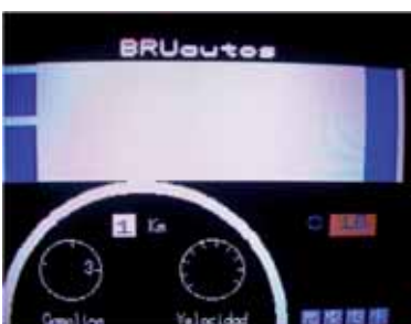
Figura 6. Pantalla del simulador de un vehículo en el que se representan los mandos sobre los que el usuario puede actuar.
