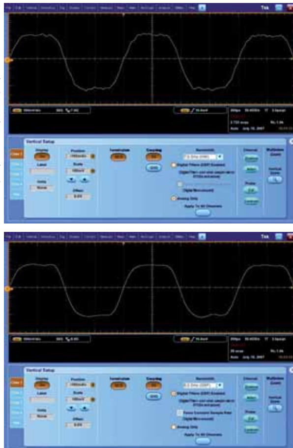
Figura 10. Señal PCI Express de 2,5 Gb/s y sonda P7380 de Tektronix con punta "Flex Small Resistor Tip-Clip" y sin filtro DSP.
