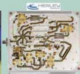
Sintetizador compacto 2 a 23 GHz
