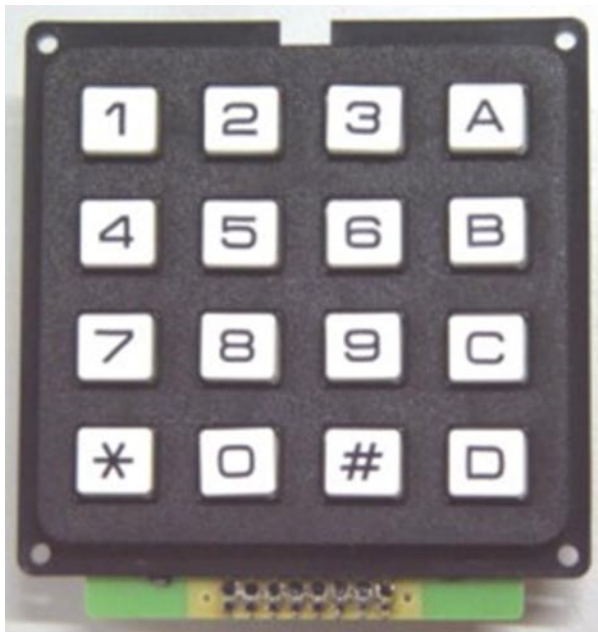
Figura 1. El clásico teclado mecánico con estructura matricial formado por 16 teclas en 4 filas y 4 columnas.
