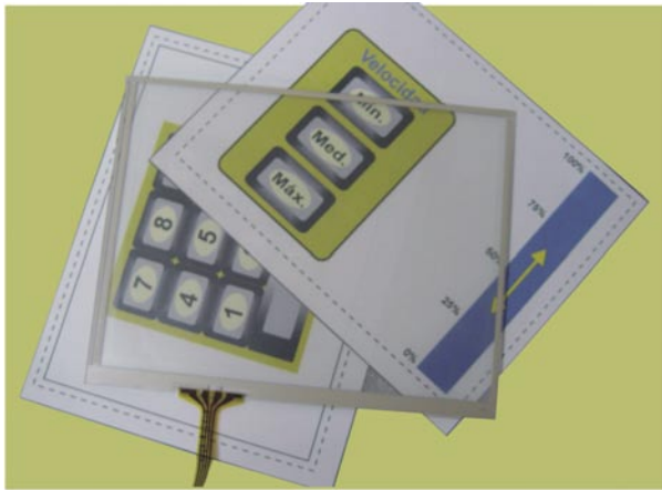
Figura 3. Fotografía de una pantalla táctil con un par de posibles plantillas. Se trata del modelo HT057A-NDOFG45 de 5,7"
