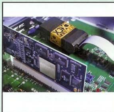
Sistemas de test y programación en circuito de componentes XJTAG.
