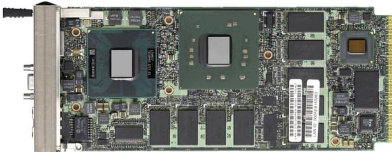
La especificación AdvancedMC fue desarrollada originalmente para proporcionar opciones de entradas/salidas intercambiables "en caliente" o una expansión del procesador para tarjetas tipo 'blade' AdvancedTCA y, por tanto, la anchura y altura específicas del módulo fueron definidas para caber dentro de ese factor de forma.
