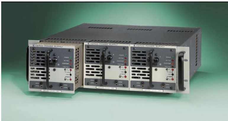
Figura 1. La serie HSP de KEPCO consiste en módulos de 1000W que cumplen con los requerimientos de los sistemas tolerantes a fallos, incluyendo redundancia N+1 con compartición de corriente, capacidad "hot swap", y rangos de entrada universales.
