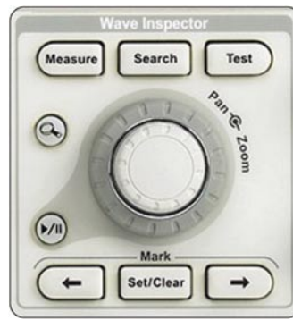
Figura 2. Wave Inspector™ – Búsqueda de eventos, marcado automático o manual de los eventos encontrados y navegación directa entre ellos.
