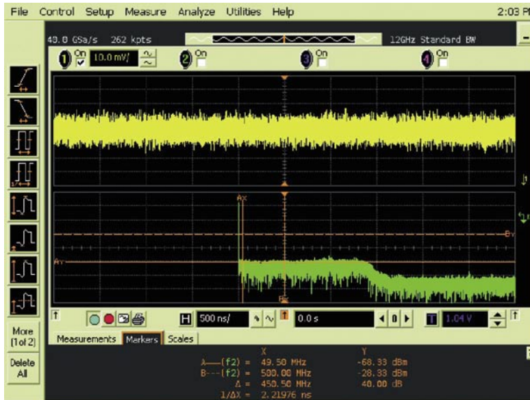
Figura 3. Análisis FFT que muestra una componente a 49,5 MHz y otra a 500 MHz junto con el ruido 'blanco'.
