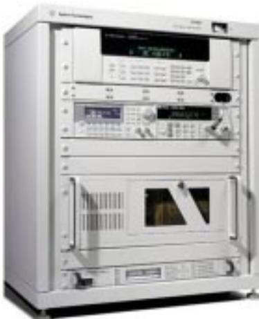
Para conseguir máxima densidad, los desarrolladores de sistemas utilizan a menudo instrumentación basada en jaulas de tarjetas. Con VXI, una jaula de tarjetas de tamaño C puede albergar hasta doce instrumentos de alto rendimiento en 6U aproximadamente, aunque esta solución tiene a menudo un coste elevado. PXI también proporciona alta densidad, si bien su compacto tamaño 4U presenta cuatro inconvenientes destacados:
