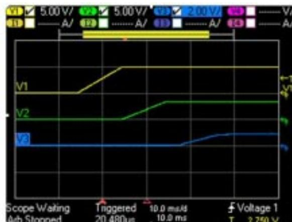
Figura 4. (izquierda) Captura de pantalla de la configuración de retardo del N6705A de Agilent; (derecha) Captura de pantalla del osciloscopio del N6705A de Agilent
