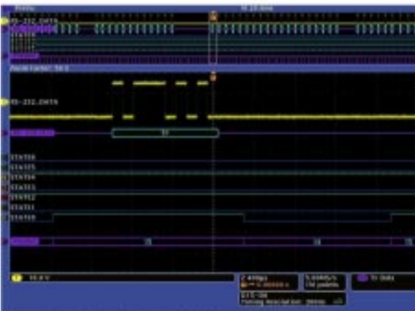
Disparo y descodificación de un bus RS232 con etiquetado de canales
