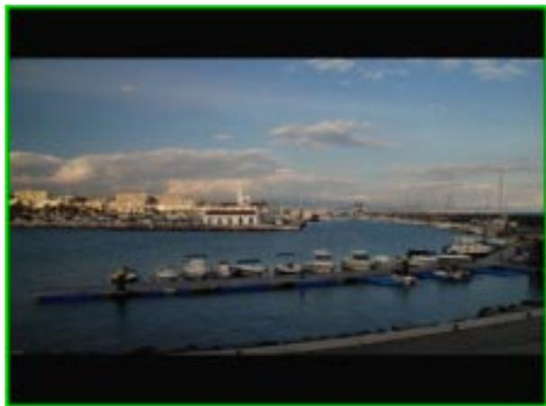
Figura 12. Ilustración del Letterbox producido por una imagen de 16:9 transmitida por un sistema de 4:3 y visualizada en una pantalla de 4:3 (centro), se pierde resolución al adaptarla pues parte de las líneas de barrido se desaprovechan.
