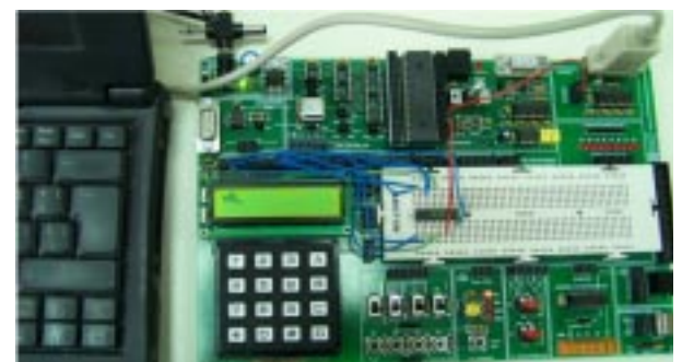
Figura 5. Sistema PIC School conectado al puerto serie de un ordenador y con la experiencia en ejecución.
