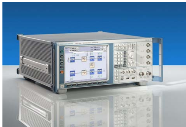
Figura 1. Dos generadores de señal en uno. El SMU200A de R&S proporciona dos caminos de RF en cuatro unidades de altura.
