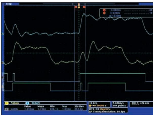
Figura 14. La diafonía generada por los flancos de subida de dos señales LVPECL provocan espurios (glitches).
