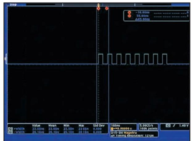
Figura 9. Adquisición realizada con un solo disparo
